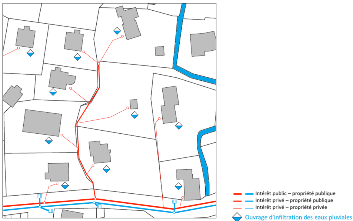
Figure 2 - Principes des mesures de gestion d'eau pluviale pour les zones d'infiltration bonne.
