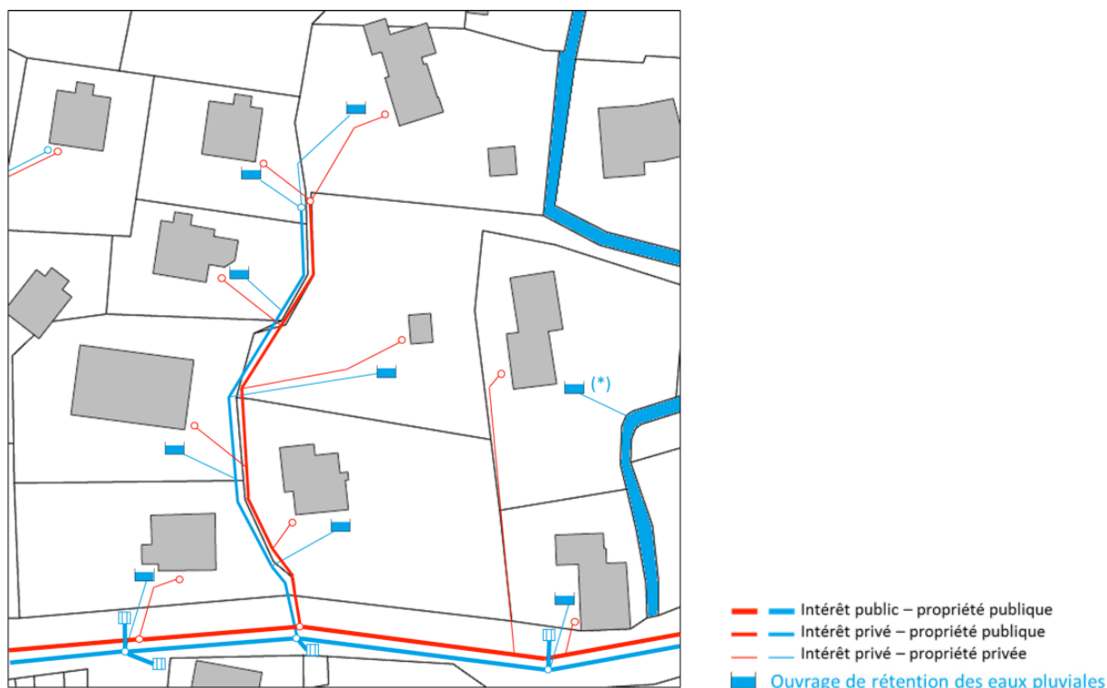
Figure 1 - Principe des mesures de gestion d'eau pluviale pour les zones d'infiltration non admise ou mauvaise.
